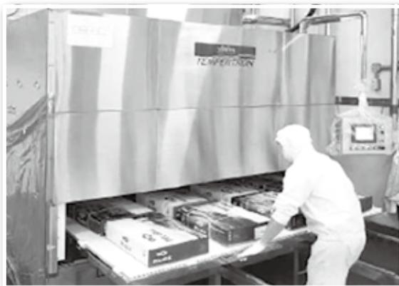
高周波解凍装置。冷凍状態の原料を包装されたまま台に並べて、解凍機に挿入する。鯖であれば10ケース(約200kg)を15分程度で急速解凍できる。
